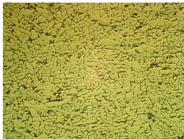
Figure 4.28: Optical micrograph of MIG welded A6063 alloy (d) Fusion Zone(FZ)
