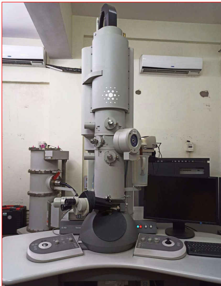
Figure 2.2 TEM instrument (Model: Tecnai G2 20 TWIN).
