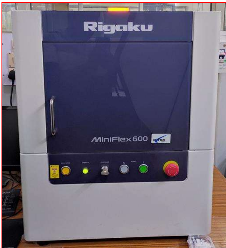
Figure 2.1 XRD diffractometer (Model: Mini Flex 600).
